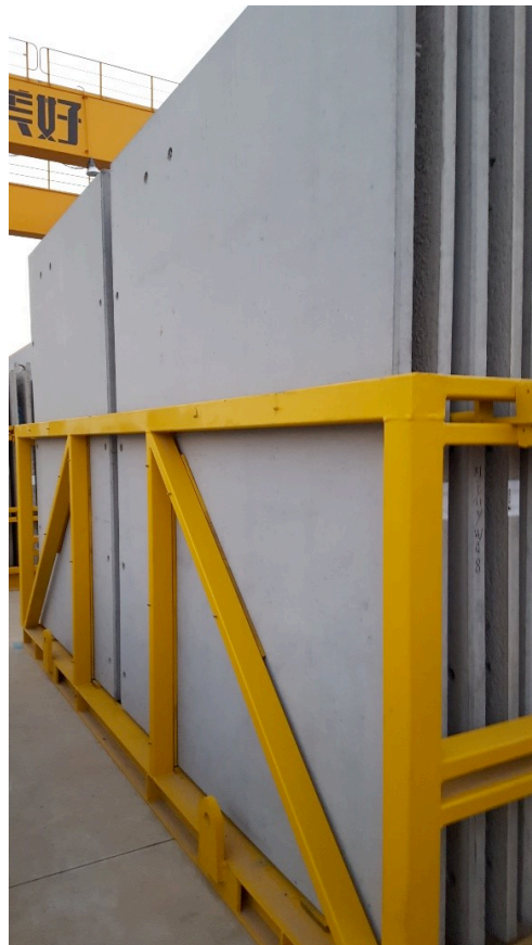
Überprüfung der korrekten Stapelung, Betonoptik, Rauheit der Verbundfuge sowie der Bewehrungslagen in China.
